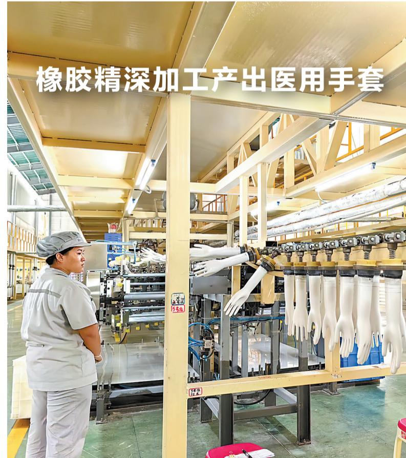
在孟连傣族拉祜族佤族自治县娜允镇，云南森洁医用乳胶器材有限公司新建的生产车间规范整洁，全自动化天然乳胶手套生产线井然有序。从天然乳胶原料到乳胶制品精深加工，公司依托普洱市天然橡胶资源优势，在普洱市建成3家医用天然橡胶原料工厂、2家医用天然乳胶手套工厂，可实现年产3.2万吨医用低氮、无氮天然乳胶和5.6亿双医用天然乳胶手套。
