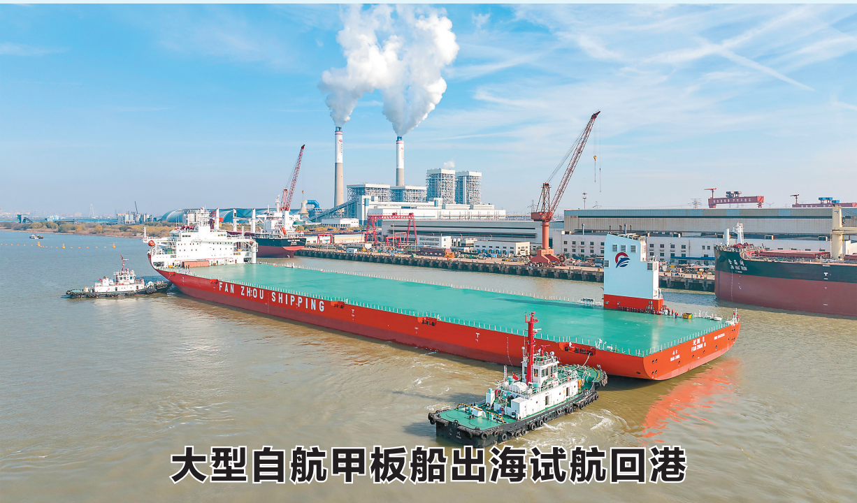
12月22日，在海事部门全程协调维护下，大型自航甲板船“泛洲8”轮从上海以东水域进行为期5天的各种专业航海测试后回港。 “泛洲8”轮总长256米，型宽51米，型深13米，最大载重量58405.4吨，续航可达16000海里，最大航速超过15节（约27.78公里/小时）。该船适航能力强，满足极地规则要求，可航行于小块漂流浮冰海域。图为12月22日，“泛洲8”轮准备靠泊在泰州众航船厂舾装码头。 新华社发 汤德宏 摄
