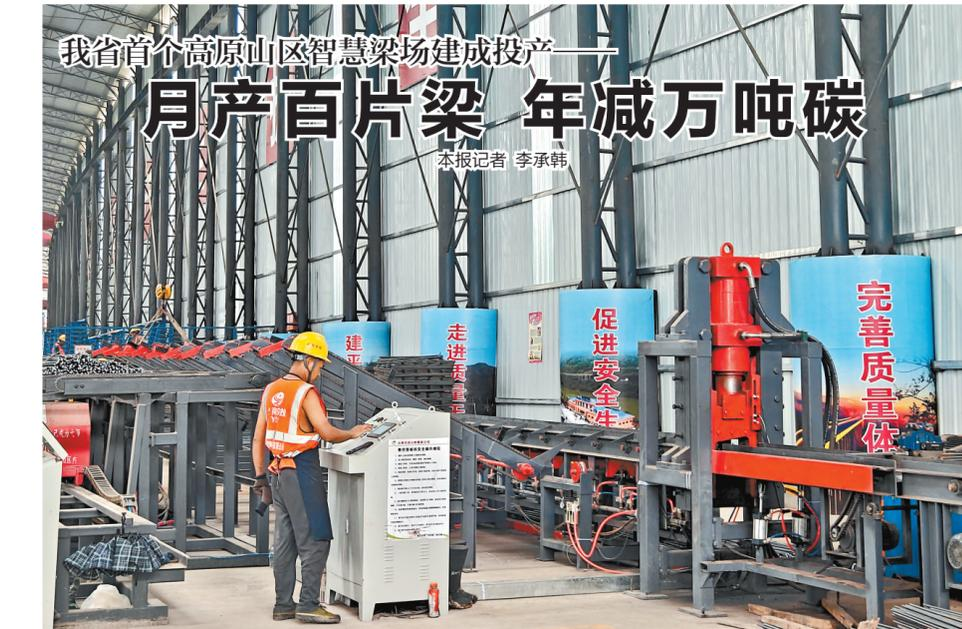
钢筋在立式弯曲中心精准成型，搭载电池的移动模板台车无声穿梭，新浇筑的箱梁乘着轨道“小火车”驶入恒温恒湿的“桑拿房”……在师宗与丘北之间蜿蜒的河谷里，一座占地仅17.2亩的“超级工厂”正悄然运转，这是云南交投集团云岭建设有限公司师宗至丘北高速公路第二合同段、30.476公里的路线穿越高山深谷，这里森林覆盖率高、生态红线分布广、桥隧比高，尤其是岭黑大桥至纳达大桥段，短短10公里需架设21座桥梁(单幅计)，预制989片箱梁，工期仅有9个月。按常规，完成如此巨量的任务至少需要3个梁场，但现实情况是，施工方仅在河谷地带找到一段440米长的路基可用。
