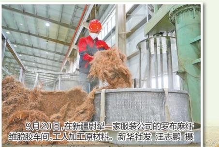
9月20日，在新疆尉犁一家服装公司的罗布麻纤维脱胶车间，工人加工原材料。新华社发 汪志鹏 摄
