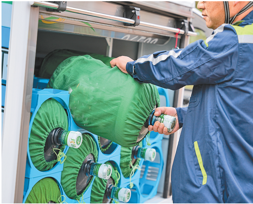
蜂巢式连体车厢设计能固定水桶
