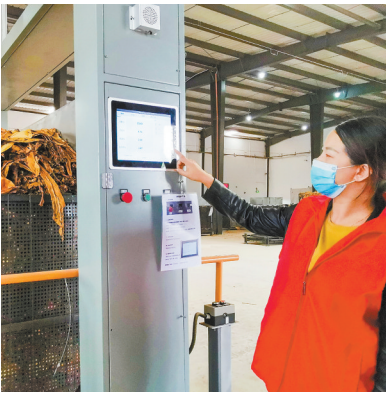
云南烟草商业使用近红外理化指标快速检测设备，检测烟叶烟碱、蛋白质等指标。
