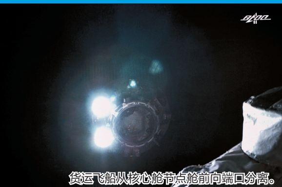
货运飞船从核心舱节点舱前向端口分离。
