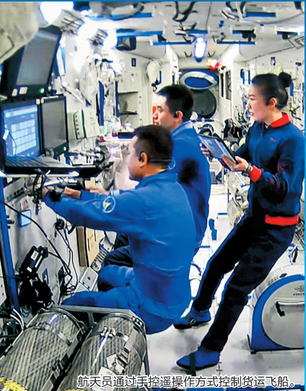
航天员通过手控遥操作方式控制天舟二号货运飞船。
