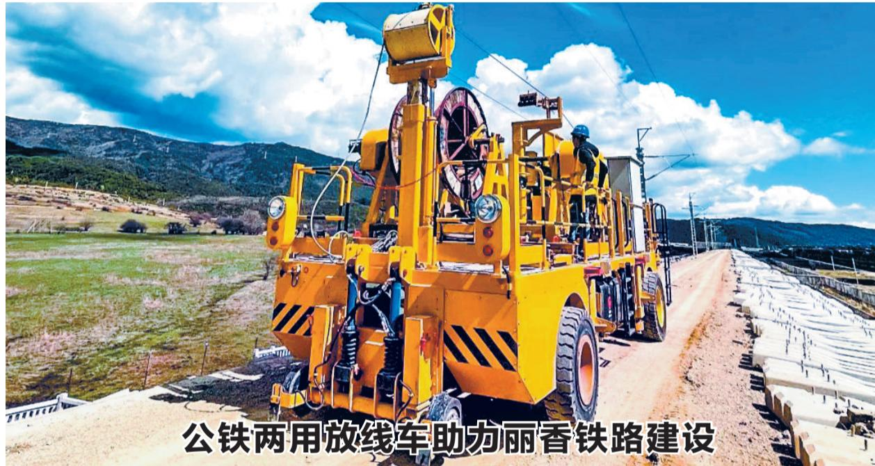
近日,铁建装备研发制造的GFX-I公铁两用接触网放线车应用于丽香铁路项目建设。该车可以在公路、铁路两种路况间随意切换,还能在走行过程中以稳定的张力放出接触线,堪称“全能型选手”,能有效解决站后铁路通信工程、信号工程、电力工程和电气化工程施工放线过程中的棘手难题。
