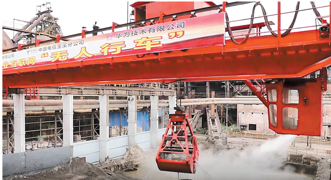
玉钢公司5G数字孪生透明工厂无人行车工作现场
