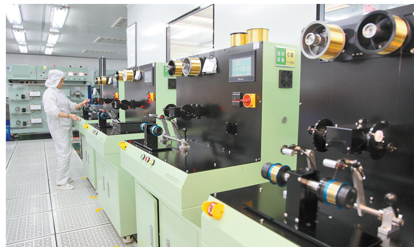
生产用于集成电路的主要封装材料键合金丝
