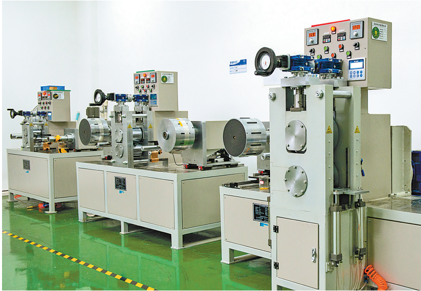
云锡研发中心锡薄片轧机
