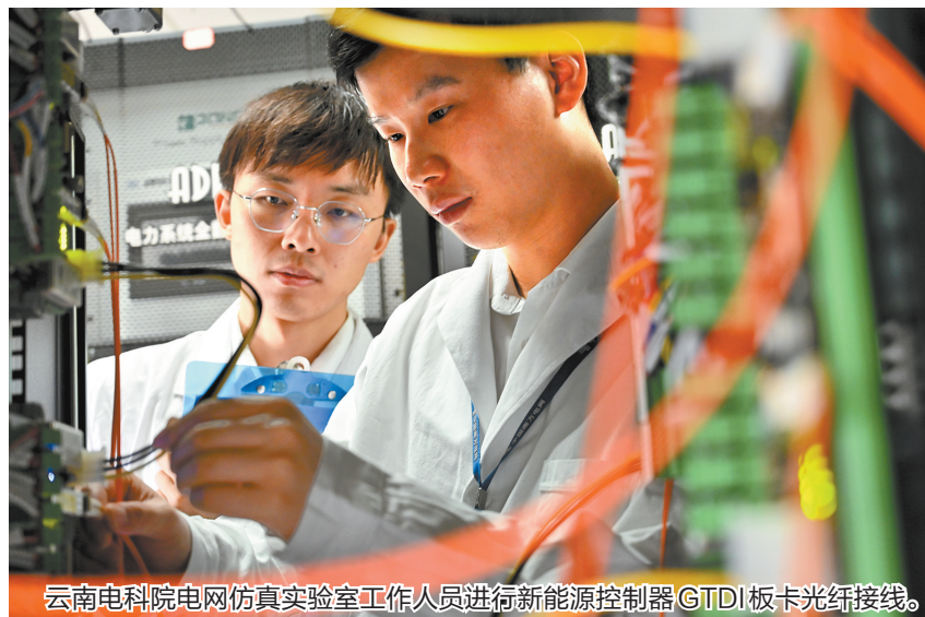
云南电科院电网仿真实验室工作人员进行新能源控制器GTDI板卡光纤接线。
