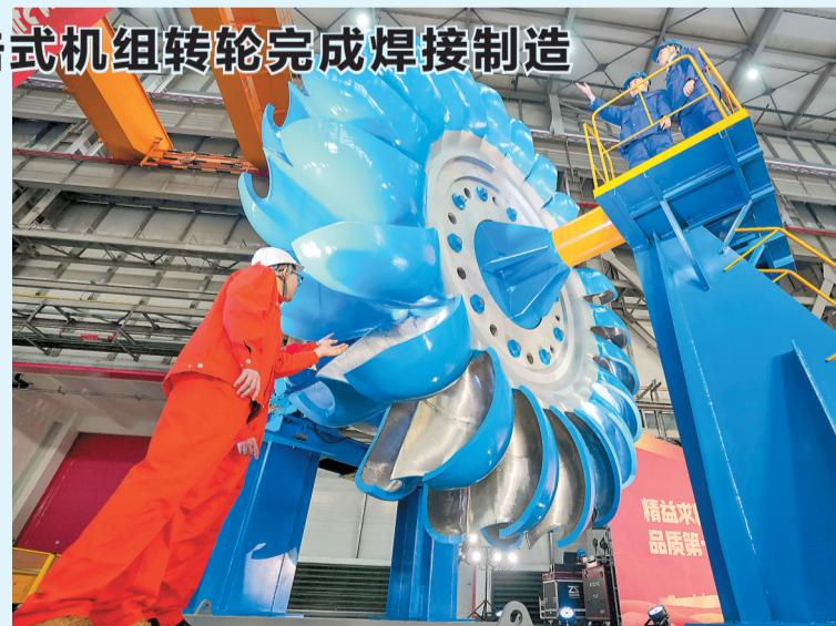
**世界首台500兆瓦冲击式机组转轮完成焊接制造**
