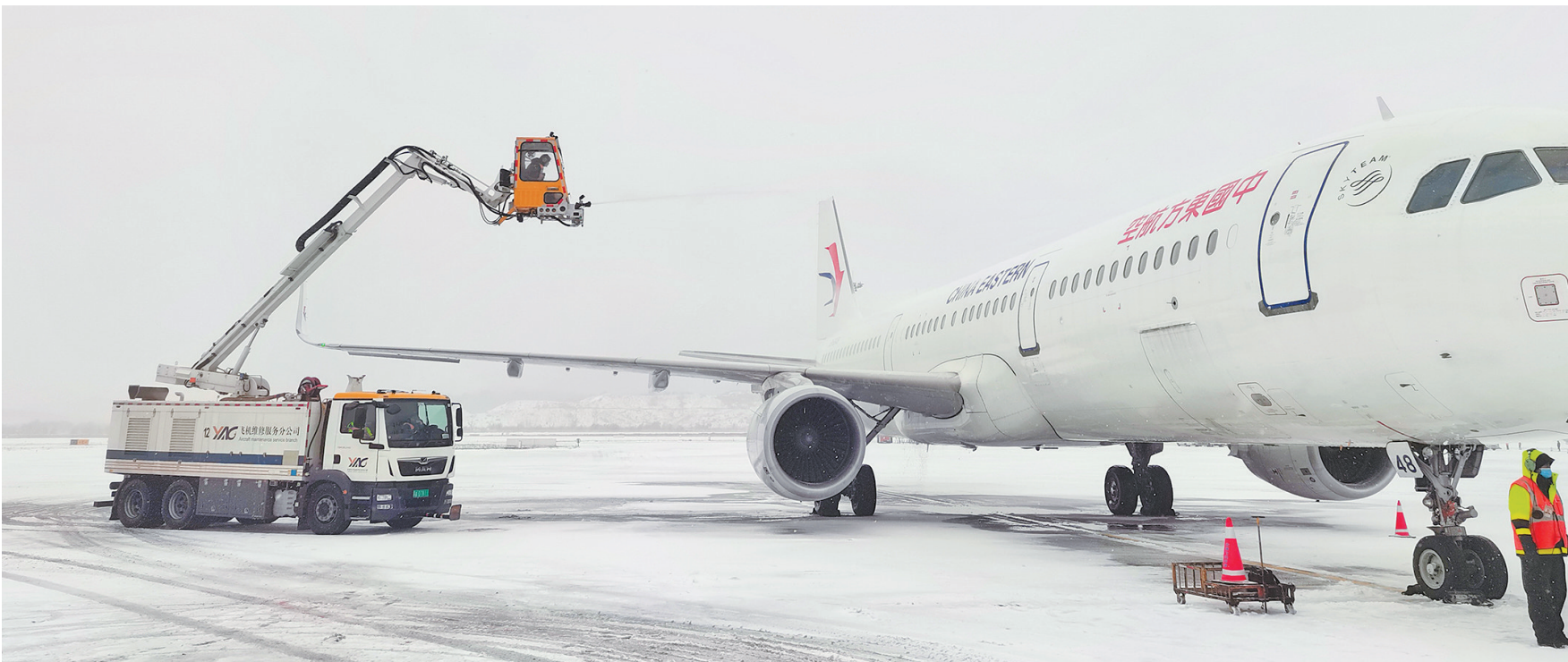
机务除冰车为出港航班进行除防冰作业。 本报通讯员 蔡兆奎 摄
